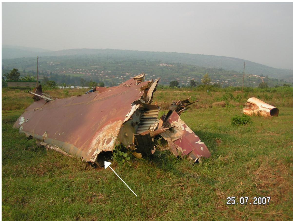
FIGURE 11 – Aile droite du Falcon 50. Le trou est visible dans le coin inférieur droit avec l’auréole blanche due au feu (indiqué par une flèche). Les volets sur le bord de fuite prouvent qu’il s’agit du dessus de l’aile droite et que le trou échancre le bord d’attaque. Photo de Pierre Jamagne, 25 juillet 2007, Kanombe.
