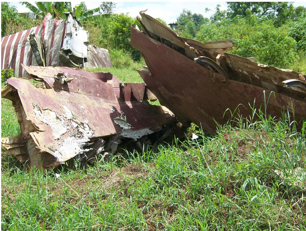
FIGURE 13 – Aile droite vue du dessous et reste de l’aile gauche du Falcon 50. L’échancrure du trou est visible près du sol (indiquée par la flèche à droite). On distingue une auréole due au feu. La flèche à gauche indique une autre anomalie sur le bord de l’aile gauche. Photo de Serge Farnel
