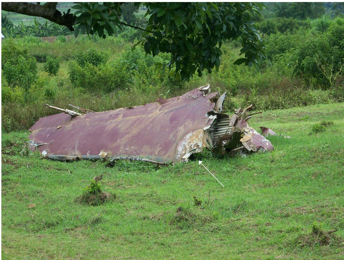
FIGURE 12 – Aile droite du Falcon 50. L'auréole due au feu et l'échancrure sont visibles sur le coin inférieur droit (indiquées par une flèche). Photo de Serge Farnel
